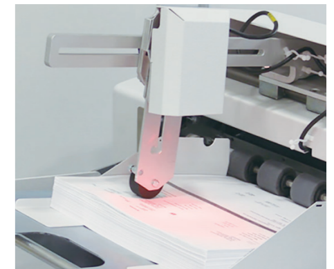
OMRモジュールはタワーフィーダー上部に取付けます。
